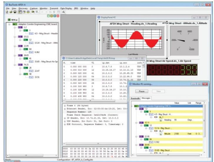
BusTools/AFDXは、AFDX (Avionics Full Duplex Switched Ethernet) トラフィックの監視、分析およびシミュレーションに柔軟性と使用容易さを提供するWindows XP/7ベースのGUIアプリケーションです。Abaco Systemsの強力なCNICインタフェースまたは標準的なNICカードで使用できるBusTools/AFDXは、アダプタ、エンドシステム、仮想リンク (VL) およびポート・レベルでAFDXネットワーク・トラフィックを閲覧、ログ、分析および生成する直感的なインタフェースを提供します。
