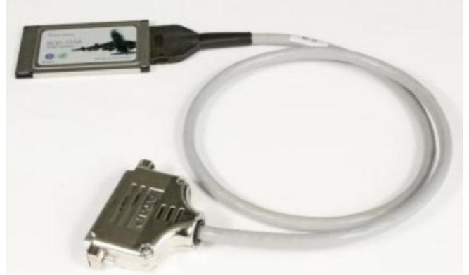
Abaco SystemsのRCEI-715Aは、高密度、最大計12までの完全独立ARINC 429/575チャンネル、最大4までの双方向アビオニクス・レベルI/Oディスクリットを提供するインテリジェントなTypeII PC Card(PCMCIA)インターフェイスです。機能は、プログラム可能なデータ速度とパリティ、エラー検知、マルチ・バッファ・モード、タイムタグおよび、自動送信スルー速度調整を含みます。ハードウェア割込みはサポートされていません。
