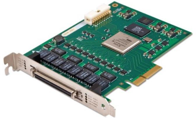
Abaco SystemsのRPCIE-1553は、PCI Expressモジュールで、MIL-STD-1553A/B NoticeIIに新世代の性能と柔軟性を与えます。-40~+70°C、1、2または、4二重冗長チャンネルが利用できるRPCIE-1553は、アプリケーションの開発時間を短縮する先進的なAPI (Application Programming Interface) を含みます。
